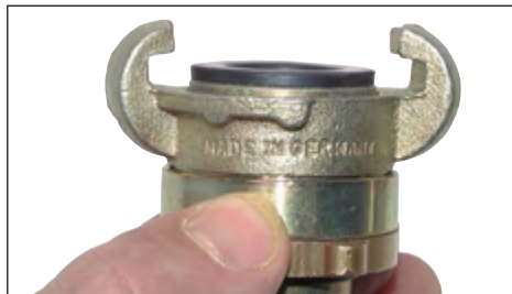
Vorgeschaubte Dichtung - Verbindung ist dicht.
